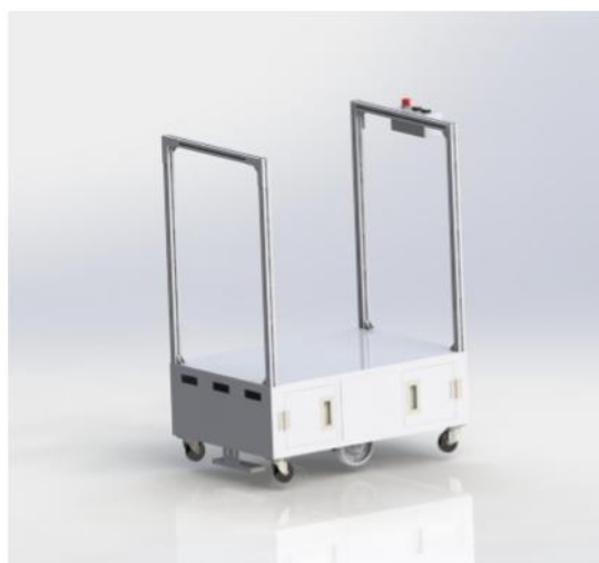
ภาพที่ 3-2 ลักษณะของรถขนส่งและลำเลียงอัตโนมัติที่ออกแบบ
