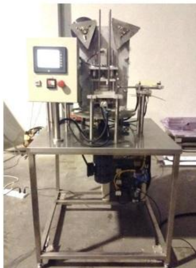
ภาพที่ 4-1 เครื่องบรรจุน้ำดื่มใส่ถ้วยพร้อมซีลฝาอัตโนมัติ
